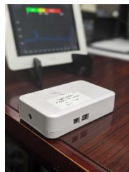
会議室に設置されたCO2センサー
